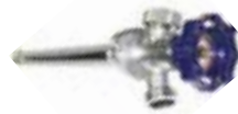
Mural. ACS. Avec traversée de mur. Purge automatique et clapet anti retour. Entrée Fil 3/4", sortie fil 3/4", traversée de 25 ou 30cm.
